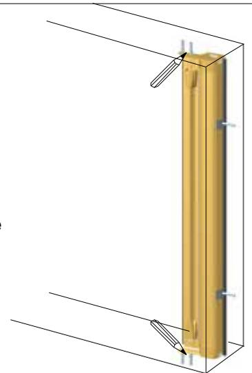
**3** Posizionare il profilo di chiusura laterale, allineato al piano del cassonetto, forare con punta da 4mm a 30cm dagli estremi del profilo, togliere il profilo, allargare i fori con punta da 6mm, posizionare i tasselli, inserire i ferma guida in alto e in basso nel profilo di chiusura, riposizionarlo e bloccare con le viti.
