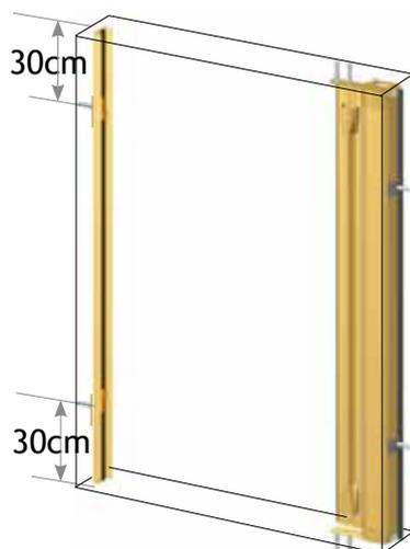
**4** Inserire le guide negli inviti delle testate sul cassonetto e bloccarle con i fermaguida sul profilo di chiusura con viti 3,5x9,5.
